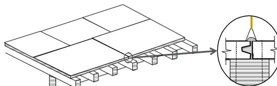
3. Poser la dalle suivante en ménageant un jeu de 2 mm puis mastiquer le vide
